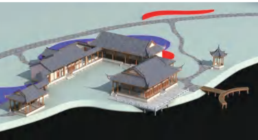
图2 使用Revit软件构建某古建筑3D模型
